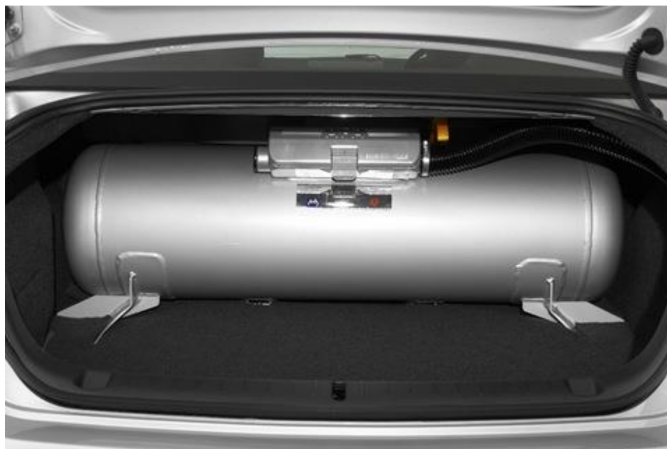
شکل ۱ - ۵ : مخزن LPG در خودرو [۷]
